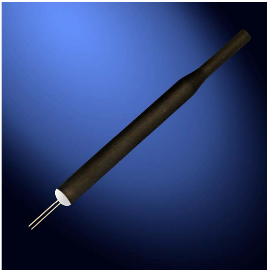
Bild 3: Hochtemperaturspitze im Inconel-Gehäuse, Einsatztemperatur bis 1.000 °C, Anwendungen: Abgassystem, Katalysator, NOx-Trap und Dieselpartikelfilter (Quelle: Heraeus Sensor Technology)
